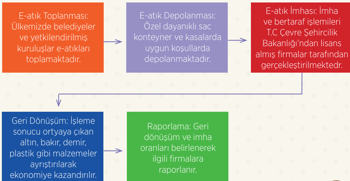
Şekil-4. E-atıkların Geri Dönüşüm Aşamaları
